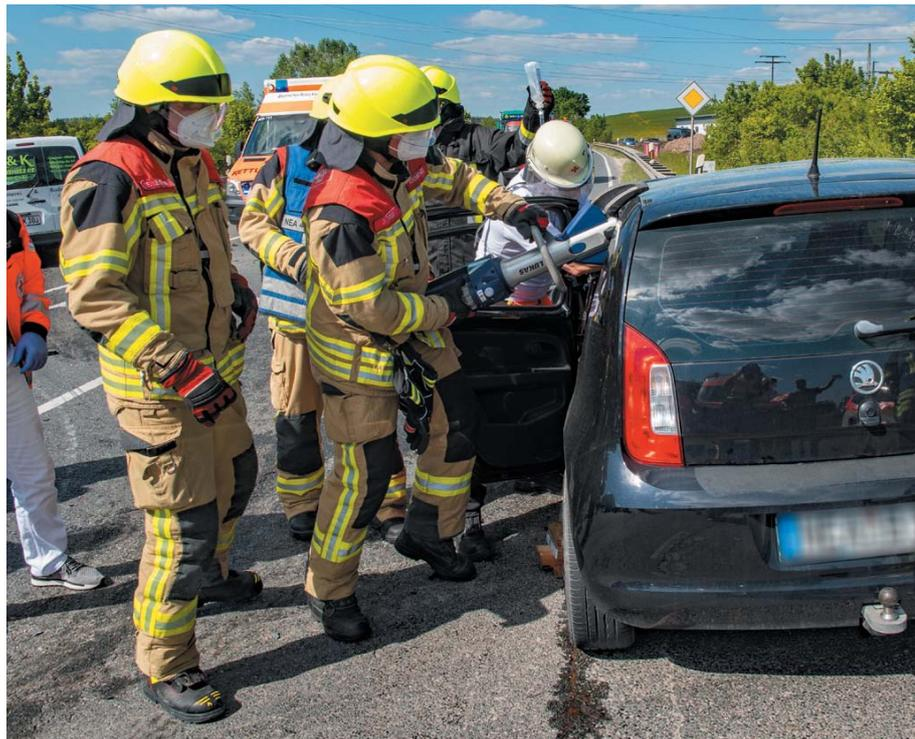
Die Einsatzkräfte der beiden Feuerwehren arbeiteten nach Rücksprache mit dem Rettungsdienst zeitgleich mit zwei hydraulischen Rettungsscheren und entfernten das Fahrzeugdach für eine patientenorientierte schonende Rettung. Parallel war auch der Brandschutz sichergestellt worden.
